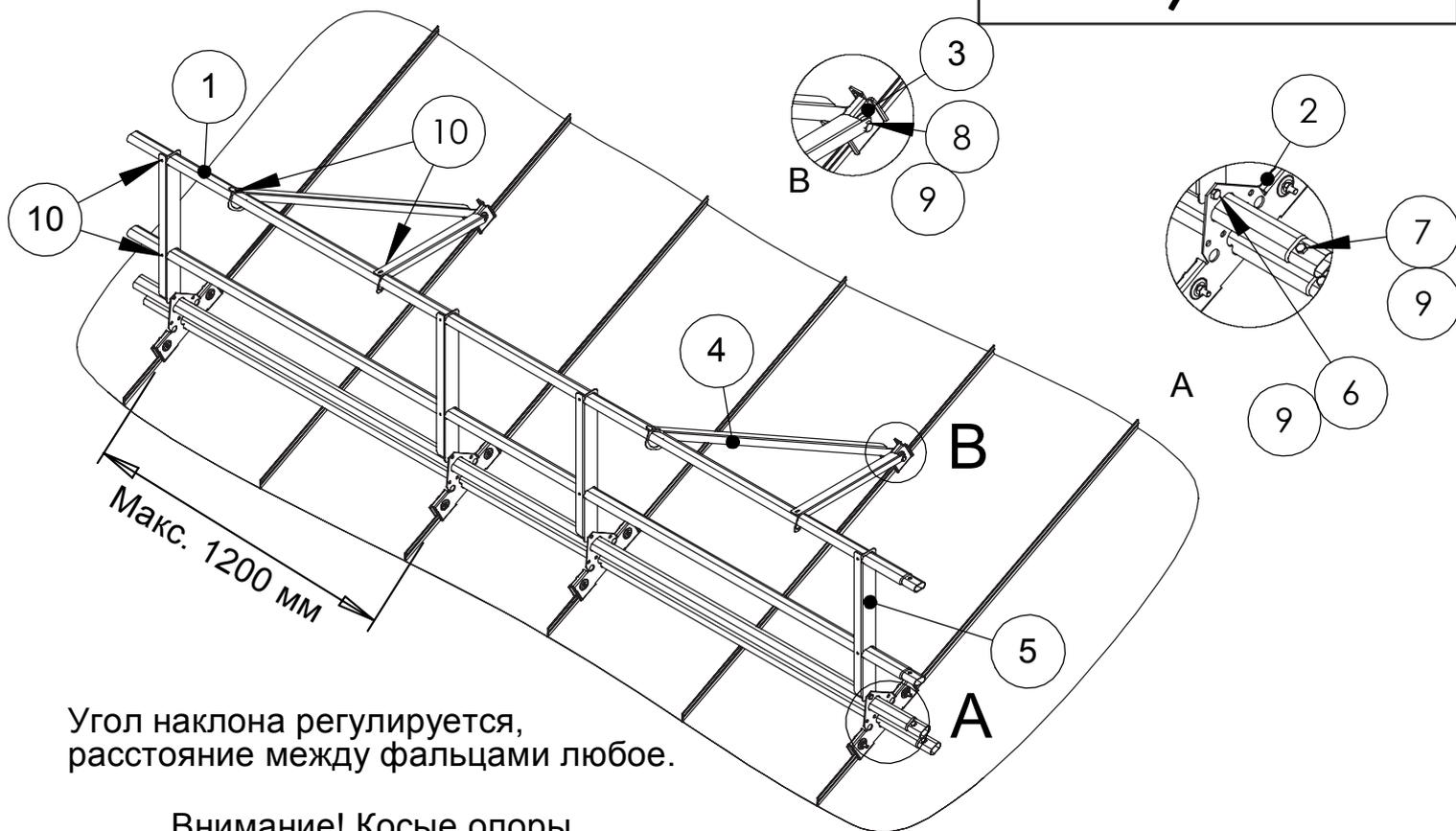
Угол наклона регулируется,
