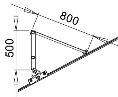
Затяжка болтов крепления к фальцу: затяните опору болтами до того момента, пока не будет достигнут предел затяга. На пределе затяга стороны опоры сходятся, но не деформированы и не скручены.
