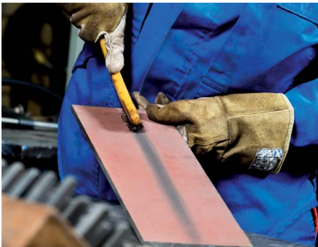
Рисунок 13: При необходимости, грунтовка легко удаляется щеткой
