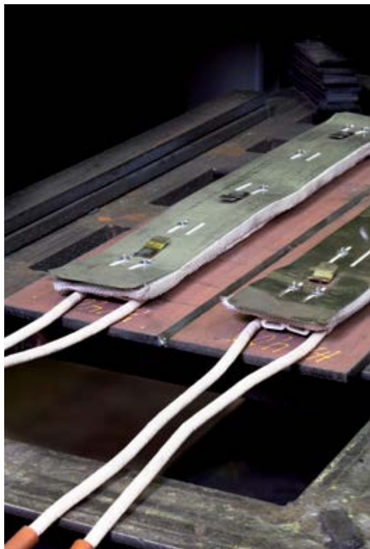
Рисунок 5: Образцы электрических нагревающих матов
