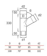
Все измерения в миллиметрах (мм). D = диаметр. L = длина.  $\alpha$  = угол  $^*$ длина по запросу
