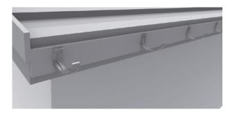
На чертеже показана установка короткого крюка жёлоба. Тот же метод используйте при установке всех крюков жёлоба короткого типа.
